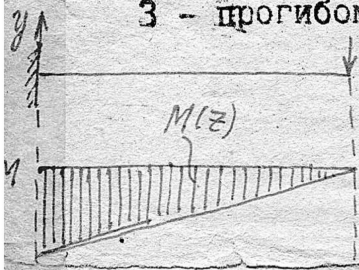
Рис. 4.5. Балка для градуировки шкалы измерителя деформаций:
