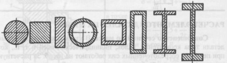
Рис. 82. Профили сечений с одинаковой площадью, расположенные в последовательности увеличения рациональности формы
