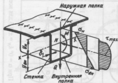
Рис. 62. Усилия, действующие в сечении шпангоута, эпюры напряжений
