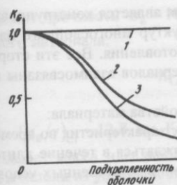
Рис. 8. Коэффициент совершенства по массе для оболочек, работающих на устойчивость:
