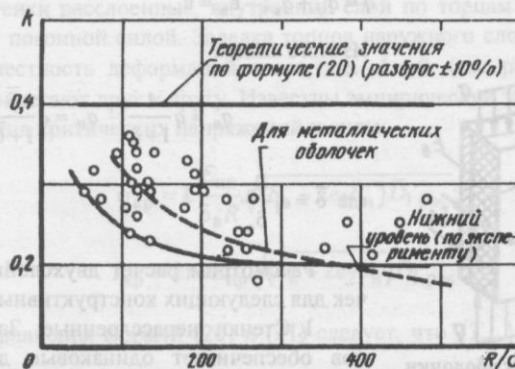
Рис. 7. Теоретические и экспериментальные значения коэффициентов k стеклопластиковых оболочек
